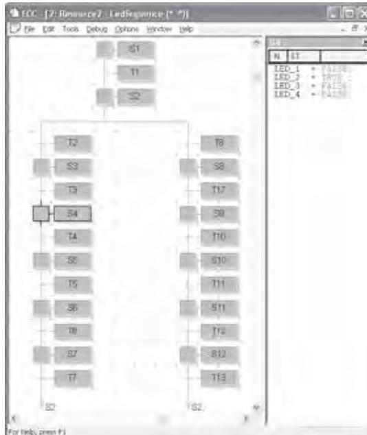
Abbildung 18-5 ECC des ‘LEDSequence’-Function Blocks.
